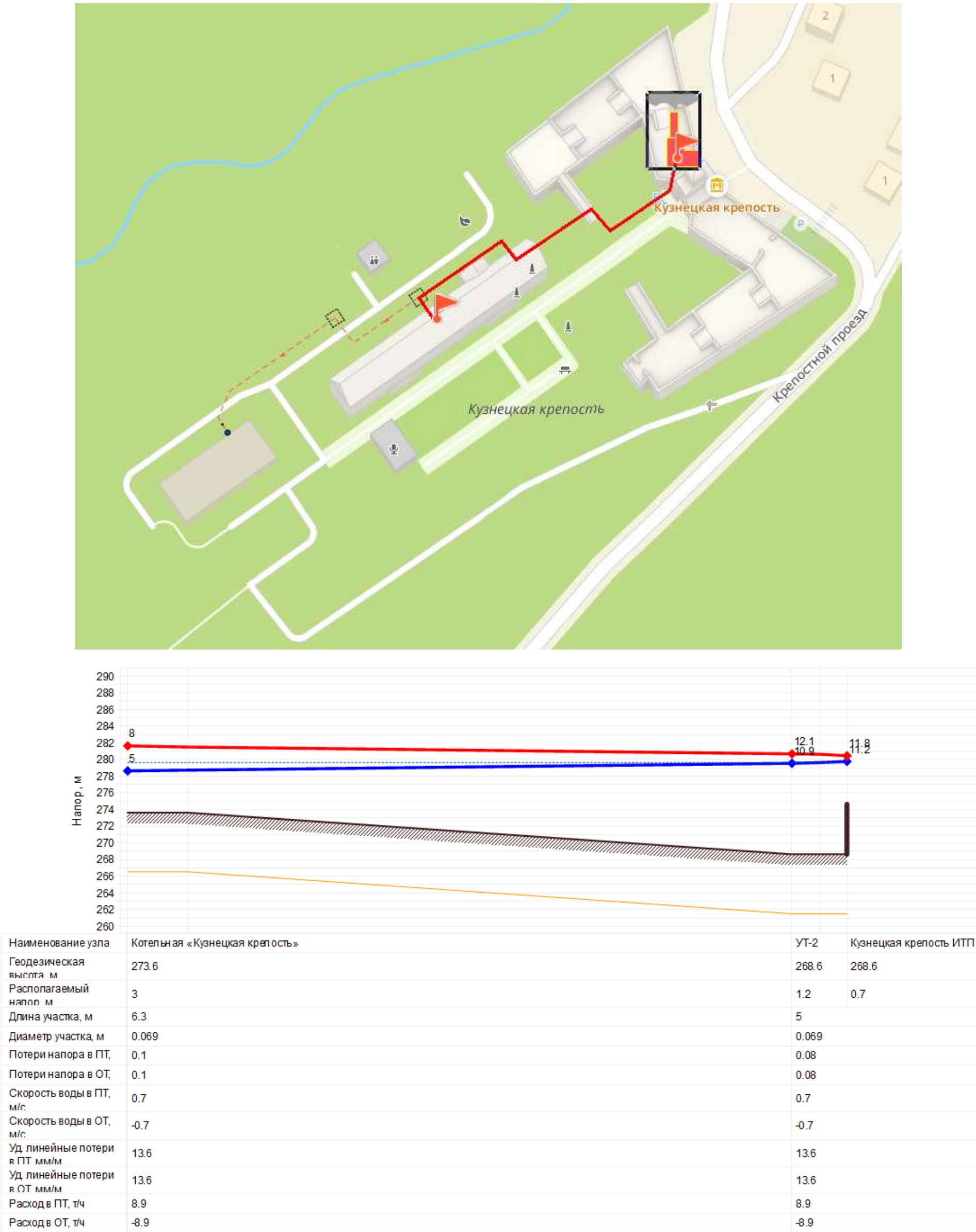
Рисунок 5.36 – Пьезометрический график магистрали Котельной «Кузнецкая крепость»
